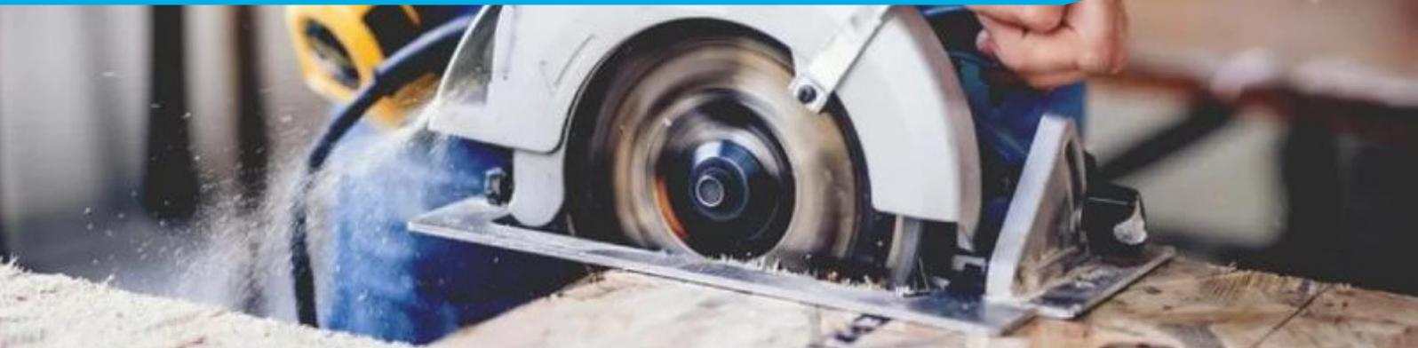
**A serra madeira possui lâmina com pastilhas de vídea soldadas a laser (também chamados de serra de vídea), que garantem um corte rápido, suave e com alto nível de segurança evitando contragolpes.**
