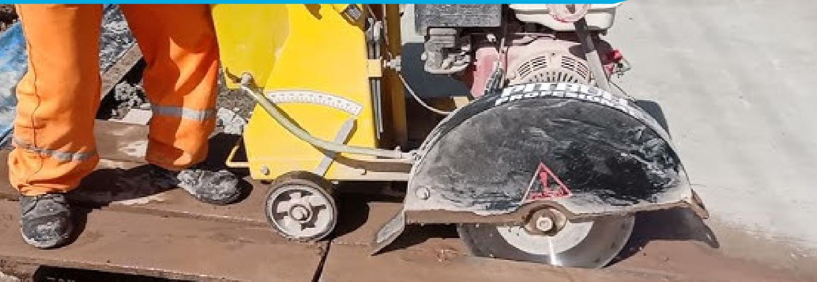
**A cortadora de piso consiste numa excelente ferramenta para realizar cortes com precisão (juntas de dilatação) em pisos de concreto e asfalto. Também conhecida como cortadora de junta ou serra clipper.**
