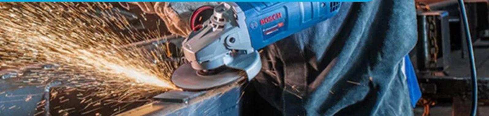
**Ferramenta Elétrica portátil utilizada para trabalhos onde é necessário esmerilhar, desbastar e cortar. É composta de motor elétrico que aciona um disco que desbasta o objeto em trabalho por abrasão.**
