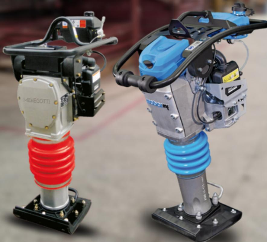
**Os compactadores de solo à percussão são destinados a compactar solos granulares e mistos com alto conteúdo de argila. Esse equipamento é muito utilizado em fundações e bases para piso.**
